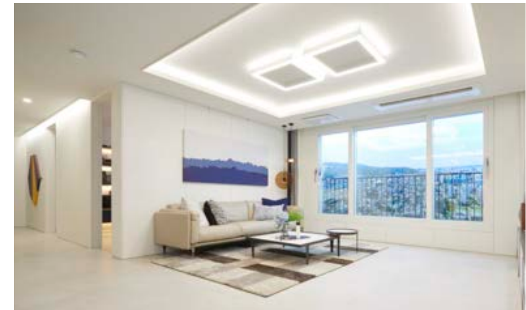
거실 우물천장 내 간접조명, 리니어 조명, 픽처레일, 시트패널
